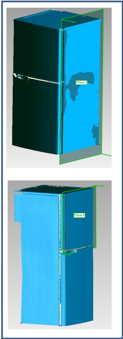
측면의 평탄도 측정 측면의 가상 Plane 생성 후 평탄도 측정
